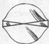
Fig. N° 156. — La mecha vista de frente. Los ángulos de corte deben formar una punta que, cuanto más aguda, más fácilmente penetra la mecha en el metal.
